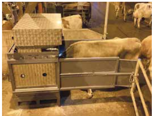
Im Projekt breed4green werden Methan- und CO 2 -Emissionen mit dem GreenFeed-System gemessen.
